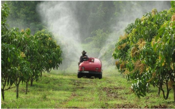
ภาพที่ 53 รถแอร์บลาสสำหรับฉีดพ่นสาร
