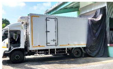
ภาพ 5.4 การทำอุโมงค์ผ้าใบป้องกันแมลงก่อนการขนถ่ายกล่องผลไม้เข้าโรงงานฉายรังสี
