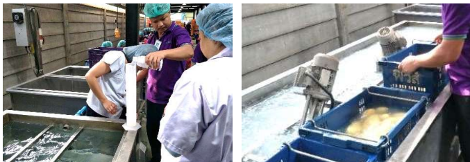
ภาพ 12 การจุ่มผลมะม่วงในน้ำร้อนอุณหภูมิ 47 – 55 องศาเซลเซียส เป็นเวลา 5 นาที ร่วมกับสารละลายอะซอกซิสโตรบิน (azoxystrobin)
