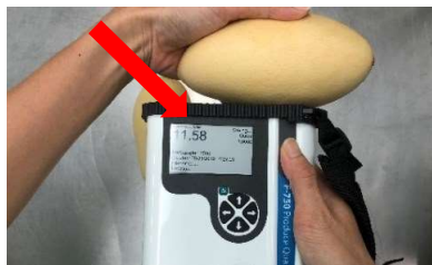
ภาพ 9 วิธีประเมินระยะสุกแก่ของมะม่วงด้วยเทคนิค Near Infrared Spectroscopy
