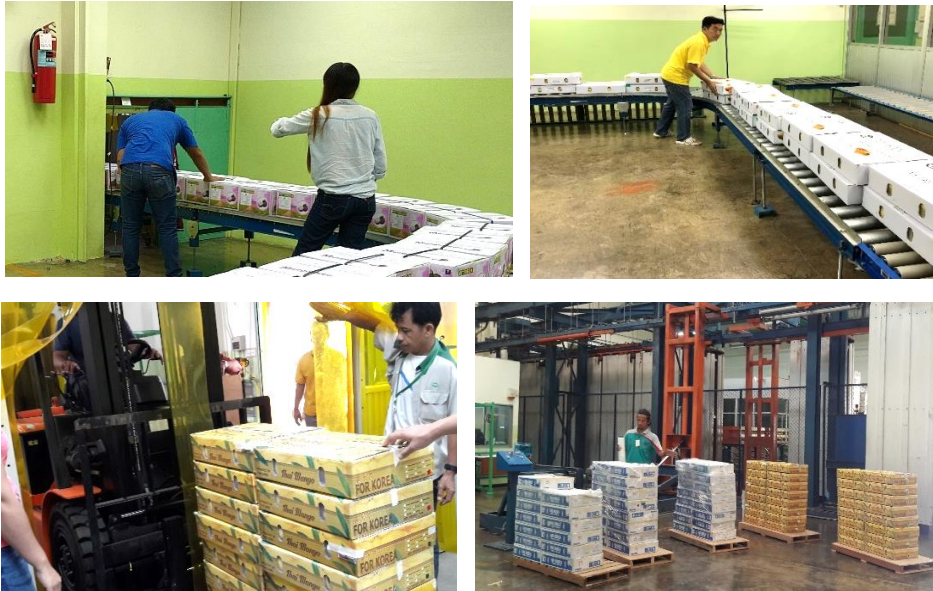
ภาพ 19 กล่องมะม่วงขณะลำเลียงเข้าโรงงานและการเรียงเพื่อนำเข้าตู้ฉายรังสี
