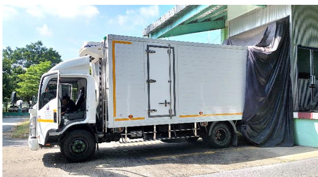
ภาพ 18 การขนถ่ายมะม่วงเข้าโรงฉายรังสีต้องทำอุโมงค์ผ้าใบป้องกันแมลง
