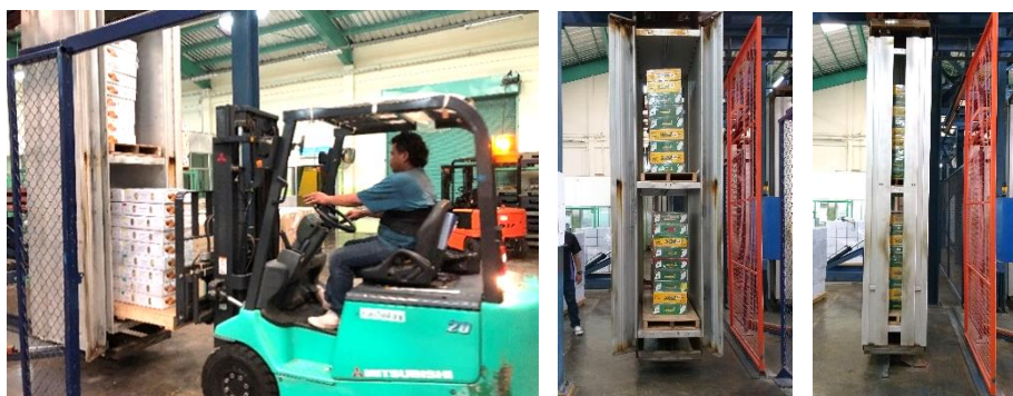
ภาพ 24 กล่องมะม่วงขณะขนย้ายเข้าตู้ฉายรังสีและการปิดตู้ก่อนนำเข้าห้องฉายรังสี
