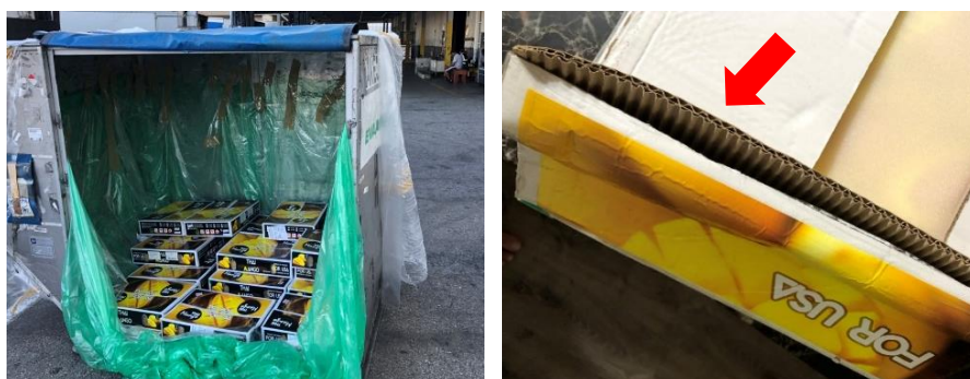
ภาพ 38 ลักษณะความเสียหายของกล่องบรรจุภัณฑ์ที่ไม่ทนความเปียกชื้น
